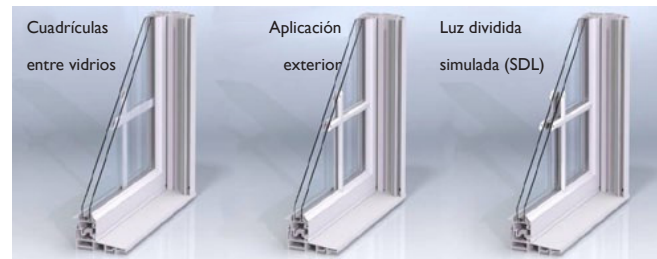
Ilustración de la diferencia entre los diseños de ventana GBG y SDL
